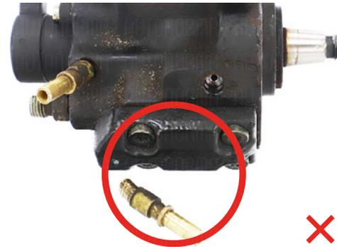
Stecker des Kraftstoff / Temperaturventils beschädigt
