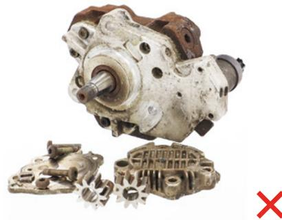
Korrosion an der Antriebswelle
